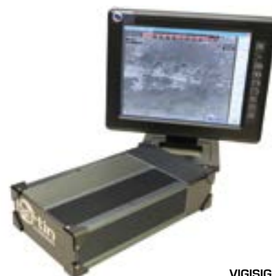
VIGISIGHT Module de traitement automatique d'images
